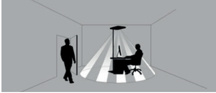
Fig. 9: Erfassungsbereich PIR Sensor.
