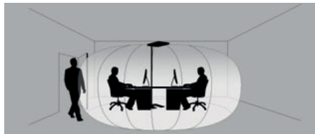
Fig. 11: Erfassungsbereich HFMD Sensor.
