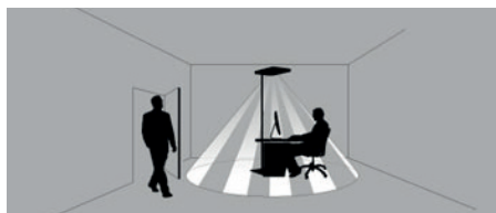
Fig. 12: Erfassungsbereich PIR Sensor.
