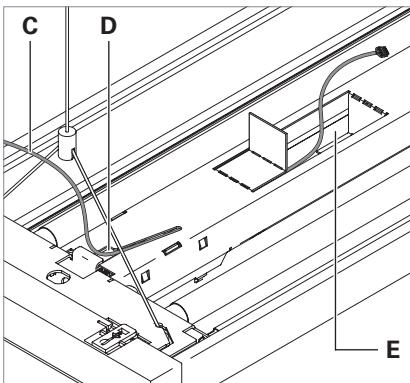
Fig. 6: Introduire le câble de raccordement.
