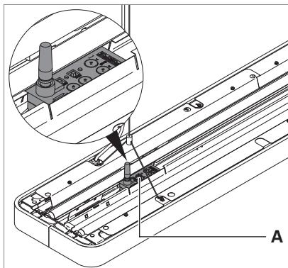
Fig. 3: Funkmodul in einer 2-flammigen ATARO-Pendelleuchte.
