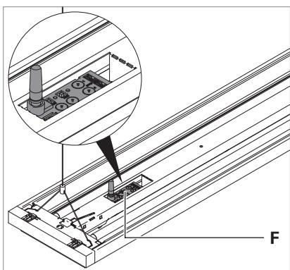
Fig. 7: Funkmodul in einer 2-flammigen TYCOON-Pendelleuchte.
