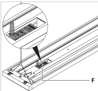
Fig. 7: Module radio monté dans un luminaire de suspension à 2 tubes TYCOON.
