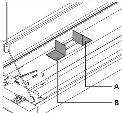
Fig. 4: Hälfte der Blechlaschen nach oben biegen.
