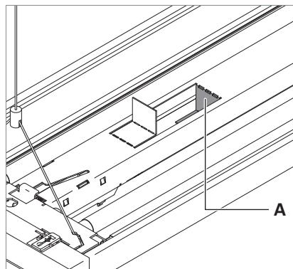
Fig. 5: Plier la languette A vers le bas.
