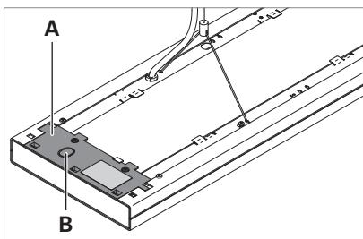
Fig. 1: Copertura dell'apparecchio d'illuminazione a sospensione LAVIGO.
