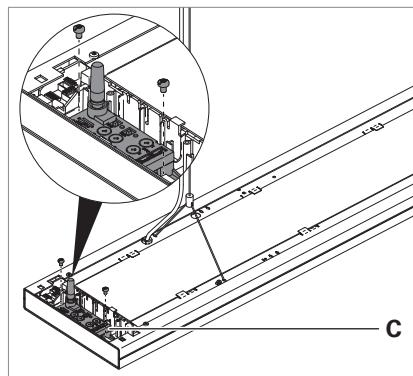
Fig. 2: Modulo radio in un apparecchio d'illuminazione a sospensione LAVIGO.
