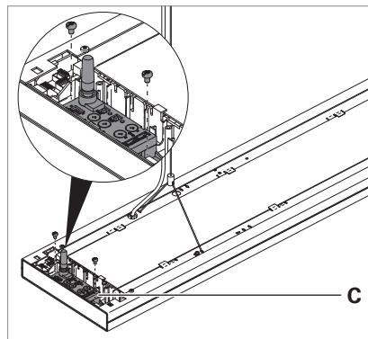
Fig. 2: Funkmodul in einer LAVIGO-Pendelleuchte.
