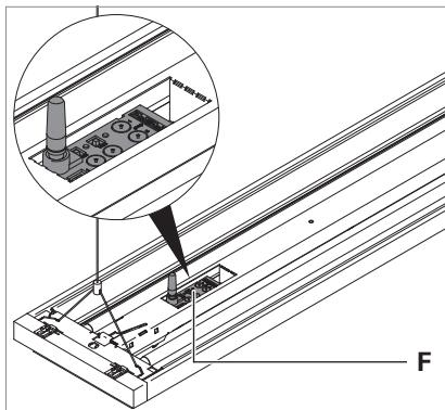
Fig. 7: Modulo radio in un apparecchio d'illuminazione a sospensione TYCOON a 2 luci.
