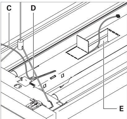
Fig. 6: Verbindungsleitung durchführen.
