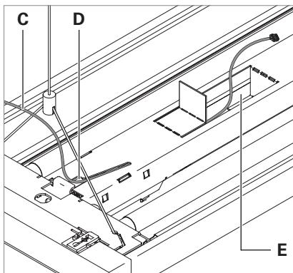
Fig. 6: Far passare il cavo di collegamento.
