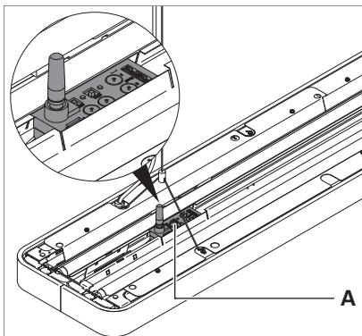
Fig. 3: Module radio monté dans un luminaire de suspension à 2 tubes ATARO.
