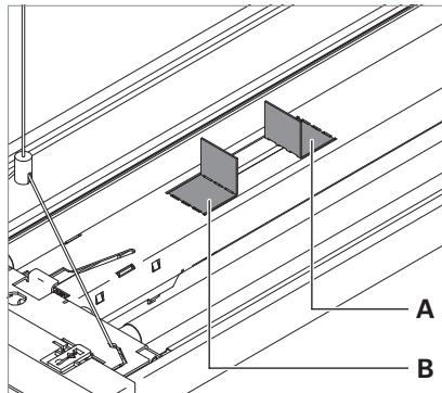
Fig. 4: Piegare metà delle linguette metalliche verso l'alto.
