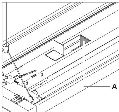
Fig. 5: Piegare la linguetta metallica **A** verso il basso.
