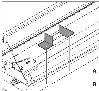
Fig. 4: Plier la moitié des languettes en tôle vers le haut.
