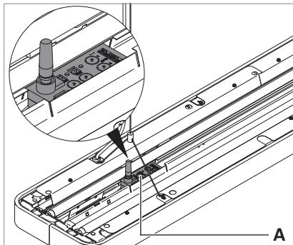
Fig. 3: Modulo radio in un apparecchio d'illuminazione a sospensione ATARO a 2 luci.
