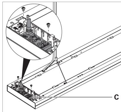
Fig. 2: Module radio monté dans un luminaire de suspension LAVIGO.
